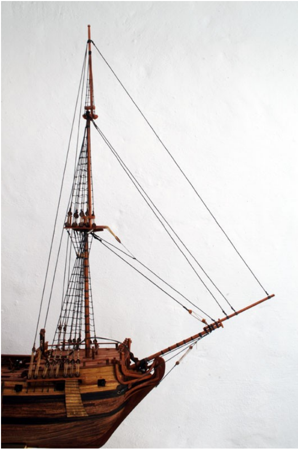
Dos ángulos del conjunto bauprés-trinquete, ensamblado y encordado
