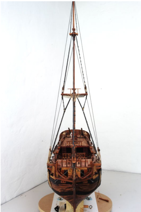
Dos ángulos del conjunto bauprés-trinquete, ensamblado y encordado
