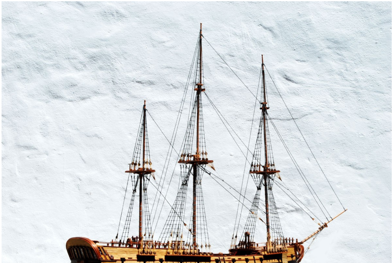
Aspecto general de la arboladura y la jarcia firme o fija
