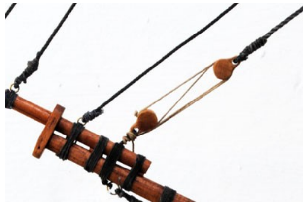
La manera adecuada de atiesar el aparejo de motones dobles
