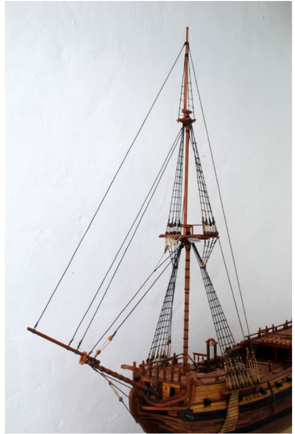
Dos ángulos del conjunto bauprés-trinquete, ensamblado y encordado
