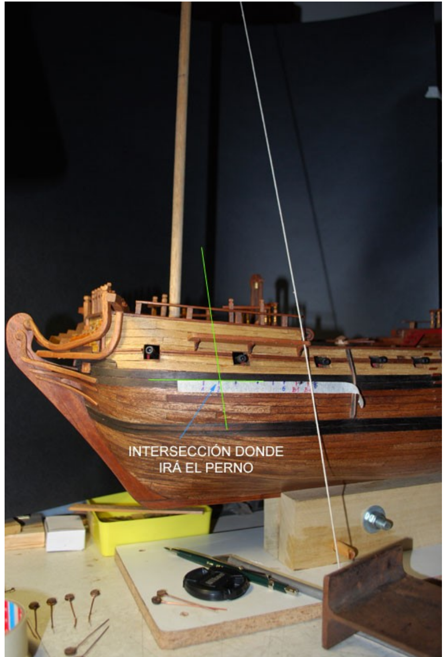
Aquí, el cordel para la segunda burda del trinquete
