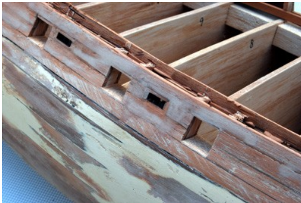
Exterior e interior de las amuras, con las troneras hechas y los mecanismos en sus sitios.
