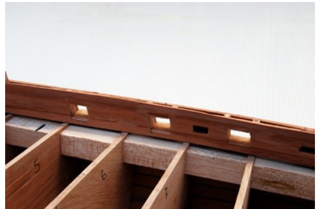
Exterior e interior de las amuras, con las troneras hechas y los mecanismos en sus sitios.
